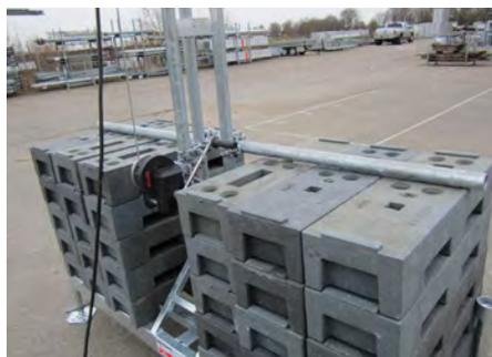
Ballastsicherung mit (Gerüstrohr 2 m und zwei Normalkuppelungen)
